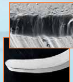
Le tranchant d'une curette traditionnelle sans revêtement et le grossissement de l'arête après le test.
