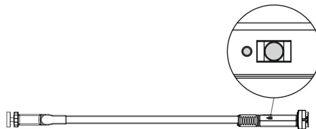
**FR** - Ne couvrez pas les trous du capteur positionnés sur la barrière afin de ne pas affecter la réception entre les deux capteurs.
