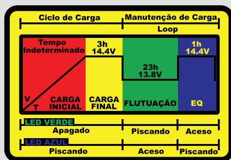
O sistema **SMART CHARGER** foi desenvolvido para controlar a carga da bateria conectada ao carregador.
