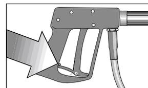
Sicherungssperre an der Pistole nach jedem Gebrauch umlegen, um unbeabsichtigtes Spritzen unmöglich zu machen!
