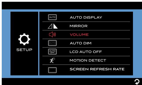
2. Tapez **x** ou **+** pour diminuer ou augmenter le volume des caméras de l'entrée et/ou de l'arrière.
