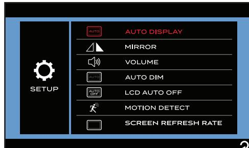
1. Appuyez sur le commutateur **AUTO DISPLAY** pour le mettre en surbrillance en rouge et activer cette fonction. Ici, vous pouvez toucher **QUAD-View** pour entrer dans le sous-menu et sélectionner la disposition de la caméra **QUAD SPLIT** ou **H SPLIT** pour un affichage à 4 canaux ou toucher **TRI-View** pour sélectionner le modèle de disposition de la caméra pour un affichage à 3 canaux.
