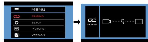
4. Presione el botón de **MONITOR PAIRING** (Emparejamiento del monitor) de la cámara (se muestra la cámara trasera) para emparejarla con el monitor.
