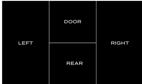
Desde la interfaz de visualización de canales, puede tocar una sección específica para ingresar en el modo de visualización respectivo de un solo canal, sin tener en cuenta si el interruptor de **AUTO DISPLAY** (VISUALIZACIÓN AUTOMÁTICA) está activado o desactivado.
