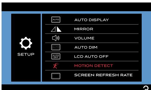
2. Tapez pour régler la sensibilité de détection de la caméra comme **LOW**, **MEDIUM**, **HIGH** (BAJO, MEDIO, ALTO) ou **X** (arrêt).
