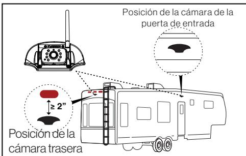
2. Utilice la junta como plantilla para marcar con un lápiz un contorno básico en la ubicación elegida. Taladre un orificio central de  $5/8"$ . A continuación, pase el conector hembra del cable de alimentación de la cámara a través del orificio y deje 2 pulgadas de holgura.
