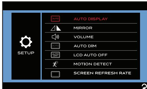
2. Toque el interruptor de **AUTO DISPLAY** (VISUALIZACIÓN AUTOMÁTICA) para resaltarlo en rojo y activar esta función. En este punto, puede tocar **QUAD-View** para entrar en el submenú y seleccionar la disposición de la cámara **QUAD SPLIT** o **H SPLIT** para la visualización de 4 canales o tocar **TRI-View** para seleccionar el patrón de disposición de la cámara para la visualización de 3 canales.
