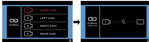
4. Appuyez sur le bouton **MONITOR PAIRING** (d'appairage du moniteur) sur la caméra (sécurité des portes/ caméra arrière illustrée) pour l'appairer avec le moniteur.
