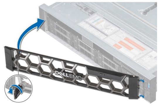
Figure 26. Installing the front bezel
