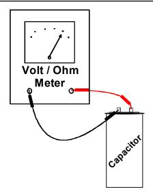
**TESTING CAPACITOR RESISTANCE**
