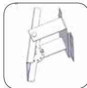
9 Schwenkkonsolen SKW40/1 und 40/2 können in jeweils 7 Winkel-Stellungen arretiert werden.
