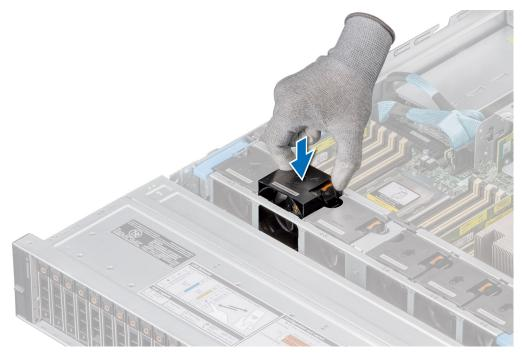
Figure 37. Installing a cooling fan
