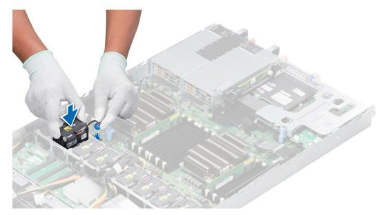
Figure 32. Installing a cooling fan
