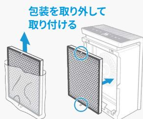
活性炭フィルタの包装を外し、プルタブを外側にした状態で本器にセットします。
