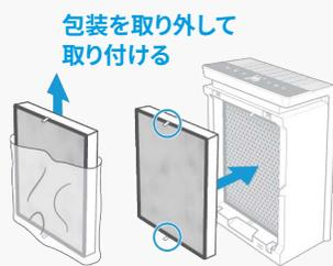
プレフィルタ/True HEPAコンビネーションフィルタの包装を外し、プルタブを外側にした状態で本器にセットします。
