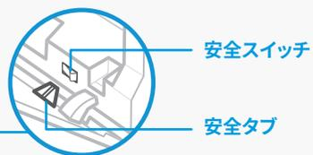
**注:** フィルタカバーがきちんと閉まっているか、カバー下部の安全タブが安全スイッチと接触しているか(接触していないと本器の電源がオンになりません)を確認してください。
