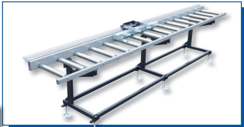
**- manuell verstellbarer Anschlagwagen mit analogem Mess-System und Ableselupe**
