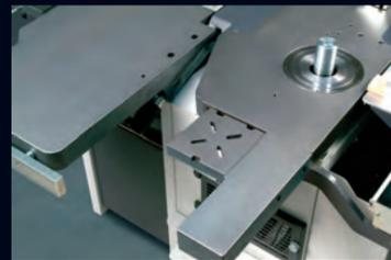
Standard-Ausführung auf die NX 310 PRO: Grusseisen Tischverlängerung mit Wegschwenk-einrichtung für Vorschubapparat.
