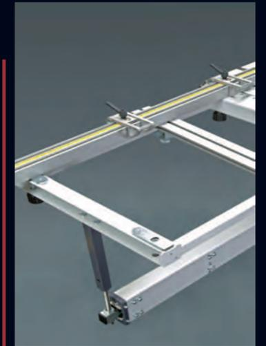
Der Quertisch auf Teleskoparm ist ausgestattet mit einer schwersausgeführten stabilen Queranschlag mit 2 Wegklapbare Anschläge. Dies ermöglicht Ihnen die Bearbeitung grosser Werkstücke.
