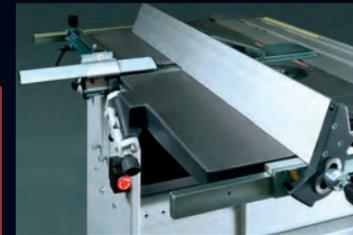
Der überdimensionierte harteloxierte Abrichtanschlag. Mittels eines SpezialSchwenkkopf liegt der Anschlaglineal auch beim Schwenken auf 45° noch auf den Tisch. Die Endanschläge sind auf 45° und 90° einstellbar.
