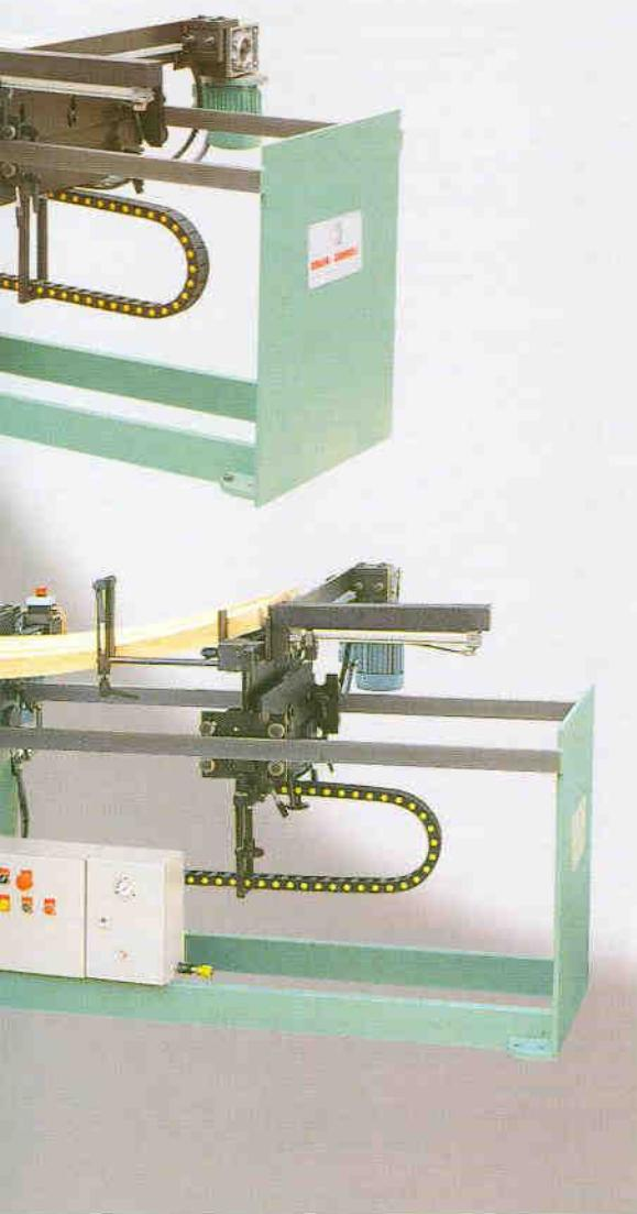
**Linea automatica** Tipo LTV composta da: Caricatore tipo CUV + Trafila tipo TV + Levigatrice tipo LT 80.
