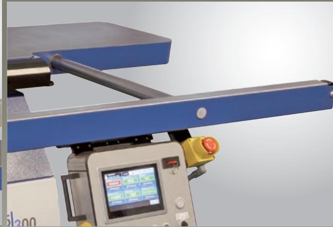
Das Bedienelement lässt sich bei Bedarf an der ausziehbaren Rahmenauflage montieren.
