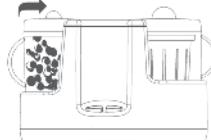
**6 -** Zavorte a zaistite veko otočením Blokovacieho systému (B) v smere hodinových ručičiek. Veko je správne nasadené, keď blokovací systém správne zapadne do drážky. Kliknutie Vám naznačí, že Mixovacia nádoba je zaistená a pripravená na použitie.
