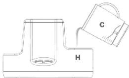
1 - Gebruik de kom (C) om water in het reservoir (H) te gieten. De hoeveelheden van benodigd water staan vermeld in het bijgeleverde receptenboekje.
