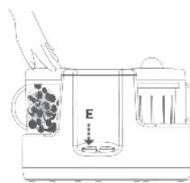
7 - Presser le Bouton de Mixage (E) pour mixer les aliments. ATTENTION : appuyer sur le bouton par petites et courtes pressions de 15 à 20 sec. maximum, pour éviter tout risque d'échauffement. Stopper si la lame de Mixage (D) tourne dans le vide.
