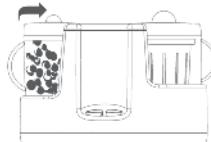
6 - Zet het deksel op de kom, en vergrendel deze door het sluitingssysteem (B) met de wijzers van de klok mee, vast te draaien. Het deksel is op zijn plaats als deze in de inkeping en met een kleine hoorbare 'klik' vast komt te zitten. De blender is nu klaar voor gebruik.
