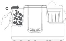
5 - Bloquer le Bol de Mixage (C) en le tournant dans le sens des aiguilles d'une montre.
