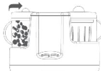
6 - Zamknąć i zablokować pokrywę obracając system zamknięcia pokrywy (B) zgodnie z kierunkiem wskazówek zegara. Pokrywa znajduje się w prawidłowej pozycji, gdy system zamknięcia jest zatrzaśnięty. Kliknięcie oznacza, że pojemnik miksuowania został prawidłowo zamocowany i jest gotowy do użycia.
