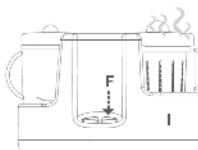
3 - Aby rozpoczęć gotowanie, naciśnąć na przycisk gotowania (F).
