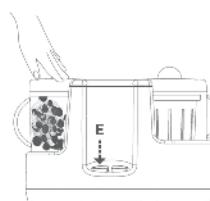
7 - Naciśnąć przycisk miksuowania (E), aby zmiksować produkty. UWAGA: naciśkać na przycisk przytrzymując krótko przez maksymalnie 15 do 10 sekund. Pozwala to uniknąć przegrzania się urządzenia. Zatrzymać, jeśli ostrze miksuowania (D) pracuje w próżni.
