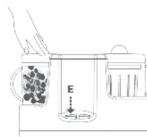
7 - Druk op de schakelaar van de blender (E) om met het pureren van de inhoud te beginnen. LET OP: druk maar een aantal korte keren op de knop, niet langer dan 15 tot 20 seconden per keer, om oververhitting van het apparaat te voorkomen. Stop met pureren als er geen voeding fijngemalen wordt door het hakmes (D).
