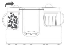
6 - Refermer et verrouiller le couvercle en tournant le Système de Verrouillage (B) dans le sens des aiguilles d'une montre. Le couvercle est bien en place lorsque le système de verrouillage est bien enclenché dans sa fente. Vous entendrez un petit clic indiquant que le bol de mixage est verrouillé et prêt à être utilisé.
