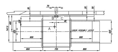
Α TANK DRAIN В WATER INLET 50/60°C - 2/4BAR С **ELECTRICAL CONNECTION**
