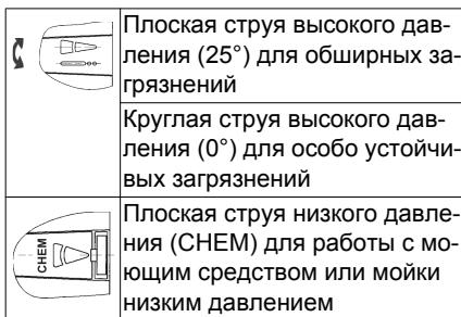
С помощью бесконтактного переключения выбрать круглую или плоскую струю:
