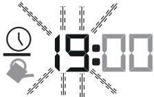
Um diagrama que mostra o display digital da unidade de comando. O display mostra o tempo '19:00'. À esquerda do display, há um ícone de um relógio e um ícone de uma mão a ajustar o relógio. O tempo '19:00' está piscando.  | <p>■ Assim que a bateria estiver inserida, a indicação avança automaticamente para o modo de ajuste para a definição da hora actual (após um curto autodiagnóstico). As horas piscam.</p> |
