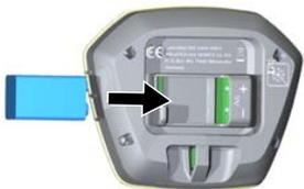
Um diagrama que mostra a parte superior da unidade de comando com o compartimento da bateria aberto. Uma bateria AA é mostrada a ser inserida no compartimento. Uma seta preta aponta para a bateria dentro do compartimento. | <p>→ Inserir a bateria correctamente (observar os sinais + / -) no compartimento da bateria.</p>                                                                                          |
