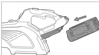
→ Zasuňte akumulátor do úchytu tak, aby bylo slyšet zaklapnutí.
