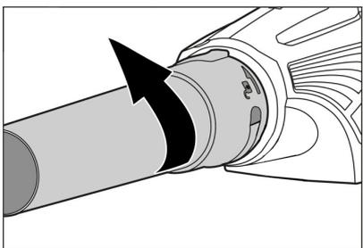
→ Okrenite ispušnu cijev ulijevo i izvadite.
