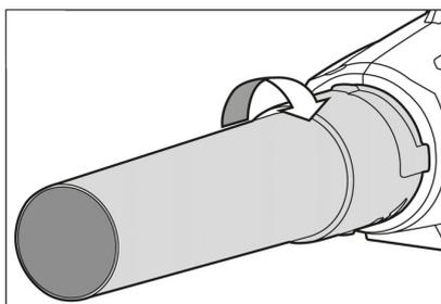
→ Tourner le tube de soufflante dans le sens des aiguilles d'une montre pour le verrouiller (raccord baïonnette).
