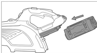
→ Spingere la batteria nell'alloggiamento, finché non si innesta udibilmente.
