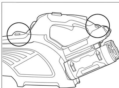
Une sangle de transport (non comprise dans l'étendue de livraison) peut être fixée sur les œilletons.
