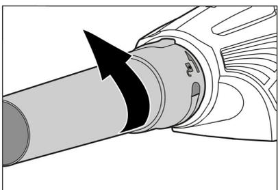
→ Трубу продува повернуть против часовой стрелки и снять ее.
