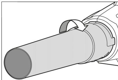
→ Blasrohr zum Verriegeln im Uhrzeigersinn drehen (Bajonettverschluss).
