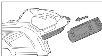
→ Inserir a bateria recarregável no encaixe até encaixar audivelmente.
