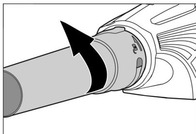
→ Blasrohr gegen den Uhrzeigersinn drehen und abnehmen.
