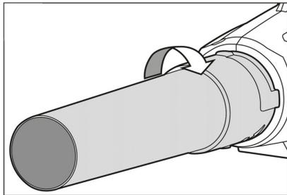
→ Per bloccare il tubo soffiante, ruotarlo in senso orario (chiusura a baionetta).
