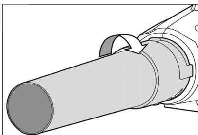
→ Girar la tubería de soplado en el sentido de las agujas del reloj para desbloquear (cierre de bayoneta).
