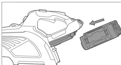
→ Установить аккумулятор в приемное устройство и задвинуть до щелчка.
