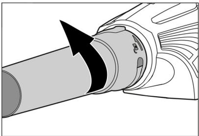
→ Ruotare il tubo soffiante in senso antiorario e rimuoverlo.
