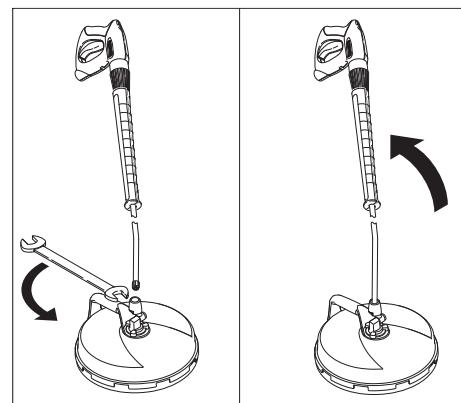
→ Brizgalno cev visokotlačnega čistilnika nataknite na FR Basic in jo z vijačnim ključem (zev 24) trdno pritegnite.
