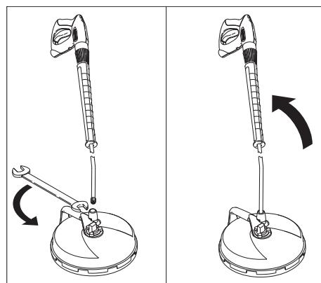
→ Przyłączyć rurkę strumieniową wysokociśnieniowego urządzenia czyszczącego do FR Basic i dokręcić kluczem płaskim (rozwartość klucza 24).
