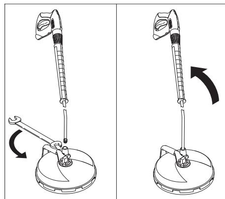
→ Collegare la lancia dell'idropulitrice all'FR Basic e serrarla con i raccordi a vite (apertura 24)
