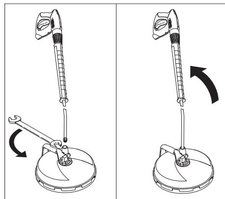
→ Prúdovú rúrku vysokotlakového čistiaceho prístroja pripojte na FR Basic a pevne dotiahnite pomocou kľúča (veľkosť kľúča 24).
