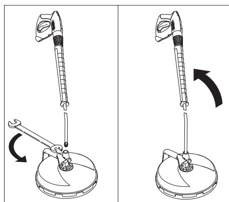
→ Стальную трубу чистящей установки высокого давления подключить к FR Basic и затянуть гаечным ключом (ширина ключа 24).
