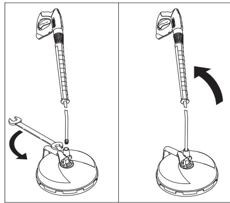
→ Yüksek basınçlı temizleyicinin çelik borusunu FR Basic'a bağlayın ve İngiliz anahtarıyla (anahtar genişliği 24) sıkın.
