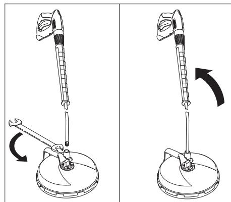
→ Надіти трубку очищувача високого тиску на FR Basic та закрутити гайковим ключем (ключ на 24).
