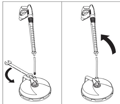
→ Tilslut højtryksrenserens strålerør til FR Basic og skru det fast med skruenøglen (nøglebredd 24).
