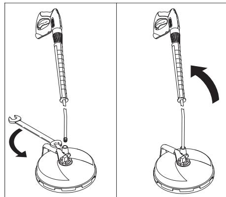
→ Raccorder le jet haute pression à FR Basic et le serrer à l'aide de la clé (d'ouverture de 24).
