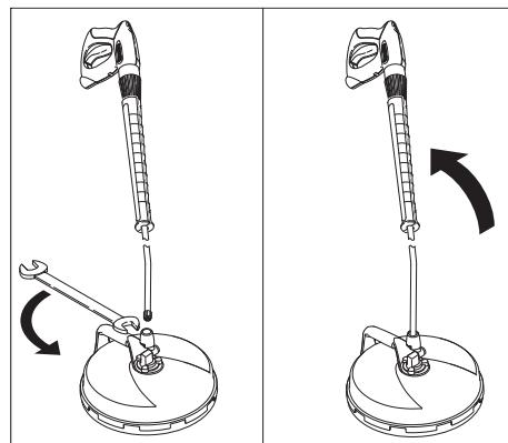
→ Strahlrohr des Hochdruckreinigers am FR Basic anschließen und mit Schraubenschlüssel (Schlüsselweite 24) festziehen.
