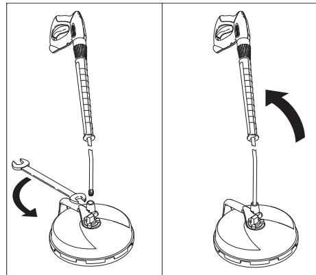
→ Straalbuis van de hogedrukreiniger aan de FR Basic aansluiten en met schroef-sleutel (sleutelmaat 24) vast aandraaien.
