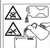
No reposte con el motor en marcha. No fumar mientras se esté repostando. No reposte directamente desde el bidón, utilice un embudo o un recipiente adecuado.
