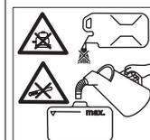
Nu alimentați cu combustibil atunci când motorul funcționează.
