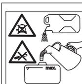
Не заправлять топливо при работающем двигателе.
