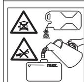
Ikke fyll på tanken med motoren i gang. Ikke røyk ved tanking. Ikke fyll på tanken direkte fra kannen, bruk en trakt eller en egnet beholder.
