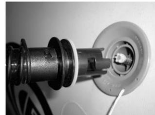
**NOTE: Cet adapter d'inflation ouvrira automatiquement la valve quand insérée et fermera la valve quand enlevée. Vous n'avez pas besoin de s'ouvrir manuellement/étroit la valve à l'aide de cet adapter spécial.**
