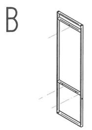
DOPO AVER TRACCIATO SUL MURO LA FORATURA (A) FISSARE IL TELAIO ALLA PARETE CON LE VITI DA MURO (B)
