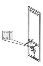
ESEGUIRE IL CABLAGGIO DEI LED ALL'IMPIANTO ELETTRICO CON UNA MORSETTERIA E AVVITARE I REGGIMANSOLA ESAGONALI PROVVISTI DI FILETTATURA MA 6 AL TELAID (C)
