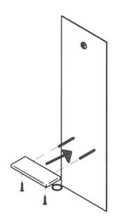
INFILARE IL PIANO FACENDOLO SCORRERE LUNGO I DUE REGGIMENSOLA ESAGONALI, ARRIVANDO CONTRO LO SPECCHIO IN APPOGGIO AI BAMPER PREFISSATI AL PIANO, SUCCESSIVAMENTE AVVIARE LE DUE VITI AUTOFILETTANTI PUNTARE SOTTO AL PIANO PER BLOCCARE LO SCORRIMENTO DEL REGGIPIANO. (E)
