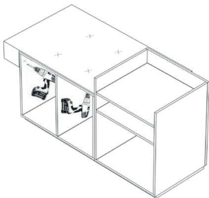
Dall'interno fissare il top al banco cassa con avvitatore e viti autofilettanti, sia sul piano attraverso le barre trasversali che sui lati.
