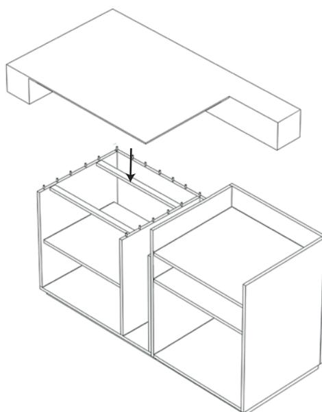
Posizionare il top con inserto con attenzione affinché combaci perfettamente con le spine di giunzione
