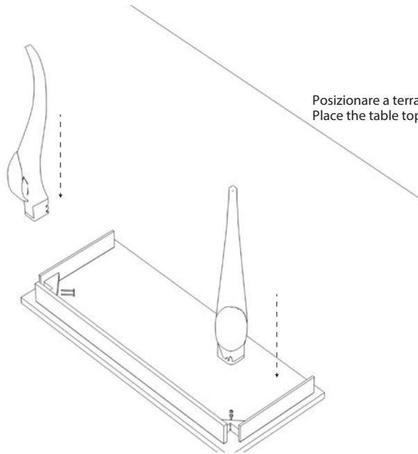
Posizionare a terra il top del tavolo con la parte inferiore rivolta in alto
