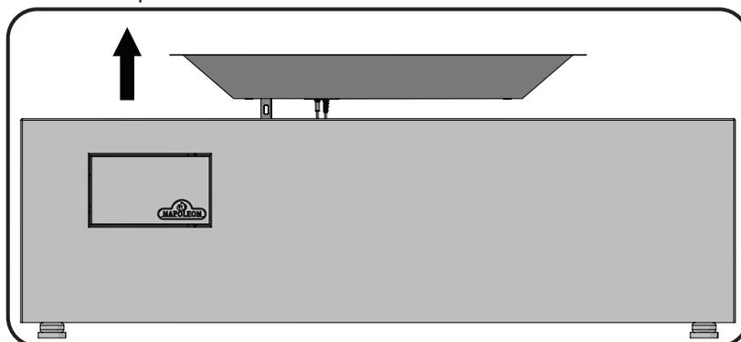
4. Débranchez le raccord flexible en acier inoxydable de l'injecteur à l'aide de deux (2) clés.
