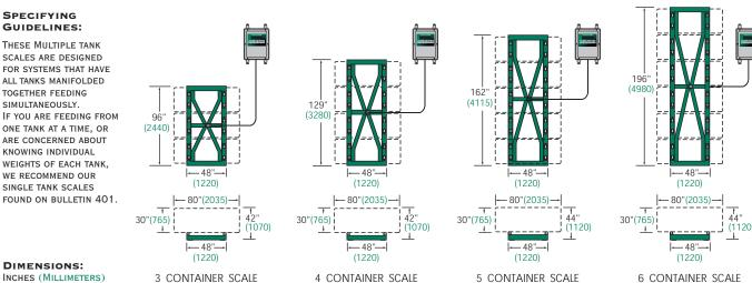
TYPICAL SPECIFICATION FOR MULTIPLE ELECTRONIC CHLORINE AND SO2 TON CONTAINER SCALE
