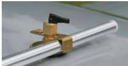
1. Imukuppi Imukuppi – liitântätangon kiinnitys myös ilman sadeuraa tai urakiskoa: Liitântäputki kiinnitetään vain imukuppiin, joka kiinnitetään ajoneuvon kuivaan ja puhtaaseen kattoon.
