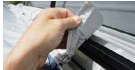
2. Magneettikiinnike Magneettikiinnike tarjoaa vielä nopeamman mahdollisuuden ajoneuvoon kiinnittämiseen. Se tarttuu tasaisiin peltikattoihin ja liitetään telttaan reunavahvikkeiden ja proÄlien avulla.
