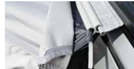
3. Reuna-kiinnikesarja Ajoneuvoihin, joissa ei ole sadeuraa, tarjoamme lisävarusteena reunakiinnikesarjan teltan kiinnittämiseen (reunavahvikkeille 5 ja 7 mm).
