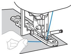
→ Dopo aver completato la cucitura, la macchina cuce automaticamente i punti di rinforzo e si arresta.
