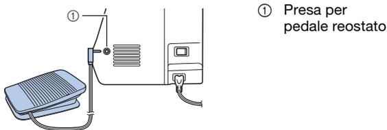
① Presa per pedale reostato
