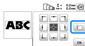
→ L'ago è posizionato nell'angolo in basso a sinistra del ricamo. Il telaio per ricamo si sposta per posizionare correttamente l'ago.
