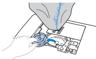
**9 Rimuovere polvere e filamenti dalla guida del crochet e dall'area circostante con lo spazzolino di pulizia o l'attacco mini di un aspirapolvere.**
