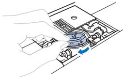
9 Rimuovere polvere e filamenti dalla guida del crochet e dal sensore filo spolina, nonché dalle aree circostanti con lo spazzolino di pulizia o con un aspirapolvere.
