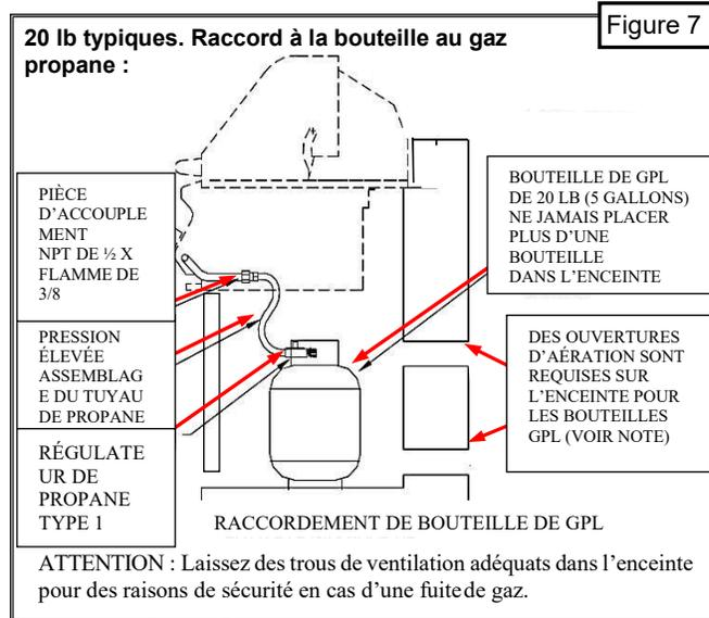
5. Le système d'alimentation de la bouteille doit être mis en place pour le retrait de vapeur.
