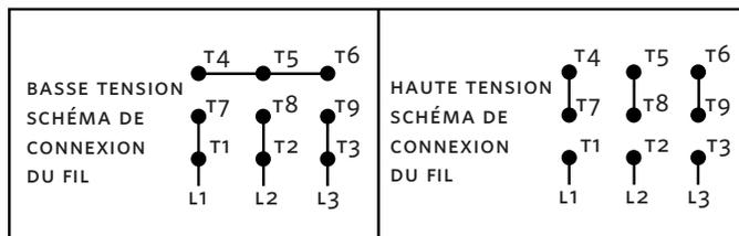
Permuter deux des fils de sorties pour inverser le sens de rotation
