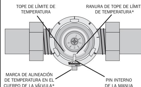
Si se desea, la configuración de temperatura se puede fijar en la VMT Webstone al fijar la manija en un lugar:
