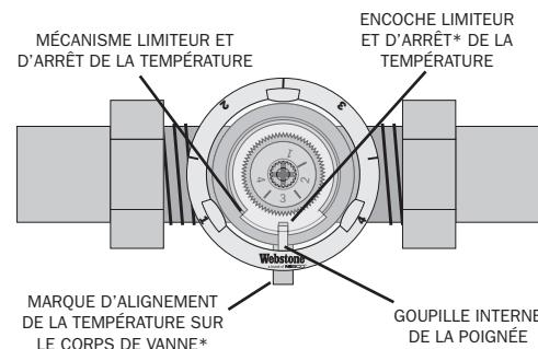
Si désiré, le réglage de la température peut être fixé sur le mitigeur Webstone en verrouillant la poignée en place :
