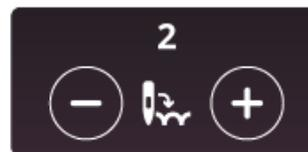
Per andare a uno specifico punto all'interno del blocco di colore, sfiorare l'icona Punto passo-passo. Si aprirà una tastierina in cui è possibile inserire il numero del punto. Se il numero inserito è troppo grande, la macchina si sposterà sull'ultimo punto nel blocco di colore corrente.
