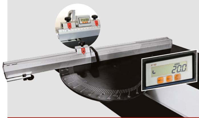
**IT** A richiesta verrà fornito un pratico pianetto per tagli angolati rimovibile, con lettura meccanica con angolazioni +/- 50° ed estensione fino a 2400 mm. A richiesta possono essere forniti visore digitale dell'angolazione della guida e/o coppia di stop digitali per una più facile lettura delle quote.
