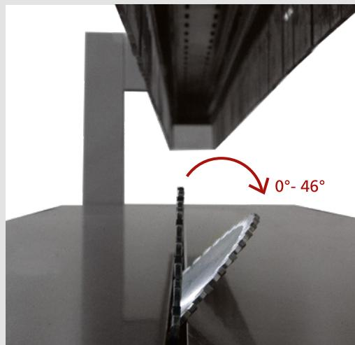
**IT** Oltre a rendere la macchina più sicura, **il pressore a tutta lunghezza** garantisce un'ottima tenuta del pezzo, ideale anche per pannelli non planari o sottili. Come ogni squadratrice di concezione tradizionale, la Concept può **inclinare la lama fino a 46°**, l'inclinazione è gestita da Plc con visualizzazione digitale decimale.
