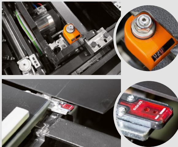
**IT** **La regolazione della profondità della scanalatura o incisione** si effettua semplicemente ruotando la boccola con contatore numerico decimale. La Concept è corredata di sistema lettura del pannello in grado di determinarne la larghezza posizionando automaticamente la lama in prossimità della fine del pannello stesso, evitando l'attesa di corse a vuoto con conseguente risparmio di tempo.
