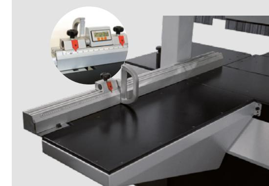
**IT** La guida posteriore motorizzata e programmabile con doppia battuta rotante (**space saving System**) grazie al suo sistema innovativo, gestisce autonomamente quale dei 2 stop adoperare in base alla misura richiesta. L'interasse tra i due stop di 420 mm permette di avere un valido appoggio per i tagli paralleli.
