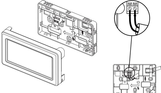
**ADVERTENCIA.** Puede dañar el dispositivo si aplica 24 V CA directamente al módulo de pared.
