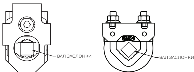
Рис. 8. Правильная установка на квадратный вал заслонки.
