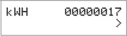
**Fig. 12. Normal Mode (kWh Reading).**
