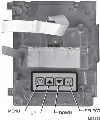
**Fig. 17. Hardware Functions.**
