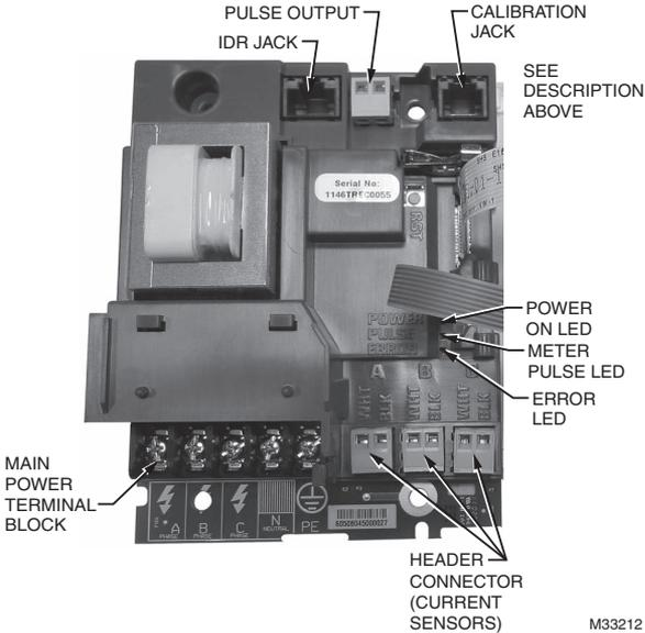
**Fig. 16. Hardware Functions.**
