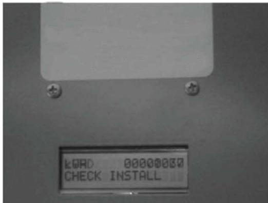
**Fig. 18. Check Install Error.**
