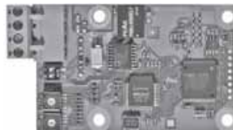
Fig. 77 Grundfos CIM communication interface module
