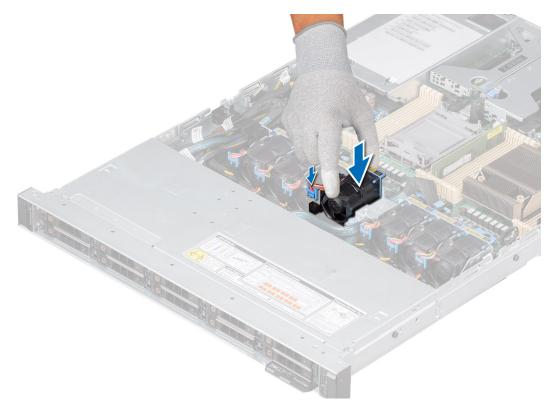
Figure 21. Installing a cooling fan
