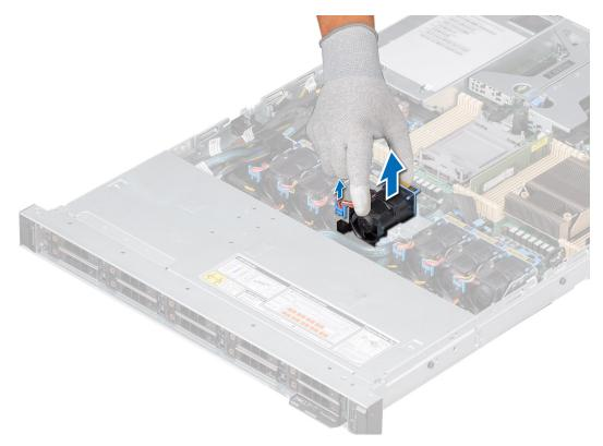
Figure 20. Removing a cooling fan
