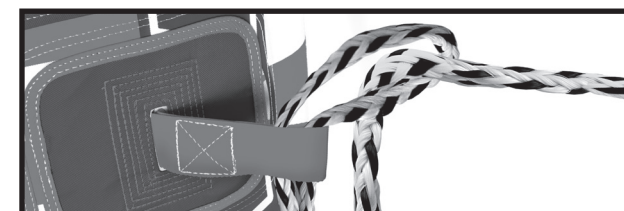
B3: Posteriormente coja el extremo de la cuerda de arrastre 2K y estire de ella pasándola por el nudo, como se mostraba anteriormente.
