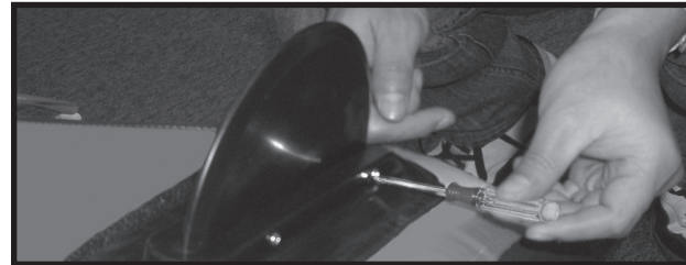
C4: Asegure y apriete todos los tornillos en todas las aletas y soportes.
