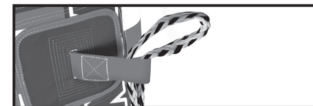
B2 : Faites passer la corde de remorquage 2K à travers et autour de la boucle du SYSTÈME DE TRACTION STATIQUE comme indiqué ci-dessus. Localisez ensuite l'extrémité de la corde de remorquage 2K.
