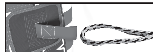
B1: Busque el lazo del SISTEMA DE ARRASTRE ESTÁTICO en la cinta de arrastre remolcable cosida al hinchable de arrastre. Busque el nudo de la cuerda de arrastre 2K, como se muestra arriba.
