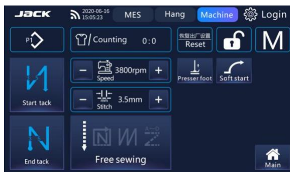
Interfaccia principale touch screen (mostra più interfacce nascoste)
