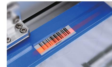
**3** Lettura programmi tramite sensore
