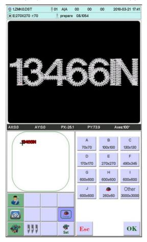
Selezionare il tipo di telaio desiderato da A-J e telaio per cappelli. Il telaio troverà automaticamente l'origine assoluta e si fermerà al centro del telaio stesso. Se il telaio non trova l'origine assoluta, la gamma di ricamo impostata vale come limite del software (per operazione dettagliata, vedi limite software impostato)
