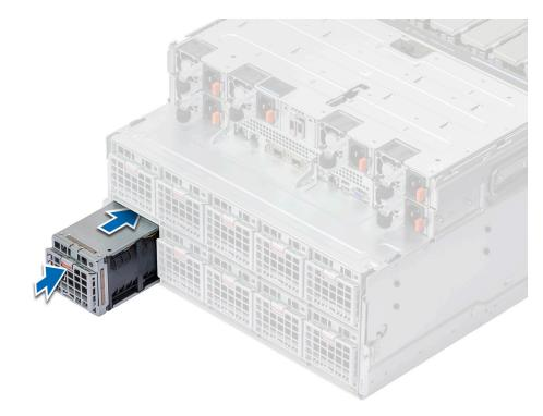
Figure 116. Installing a GPU fan module
